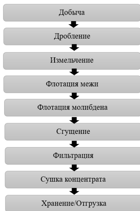
Рисунок 1.1 – Обобщенная технологическая схема переработки медно-молибденовых руд
